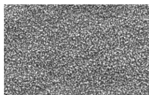
超低轮廓电解铜箔 (已处理的表面) x 3,000
